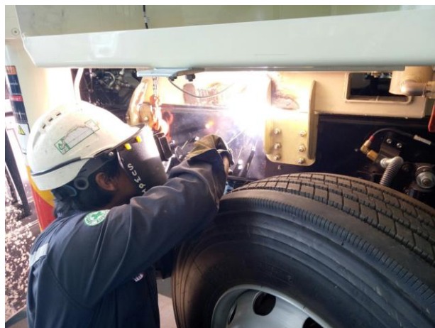
รูปแสดงการเชื่อมไฟฟ้าที่ใช้แก๊สปกคลุมในการเชื่อมสำหรับประกอบรถบัสคอนกรีต
